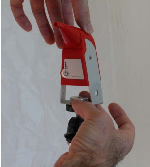
Illustrazione 6: Montaggio di IntegraMouse Plus
