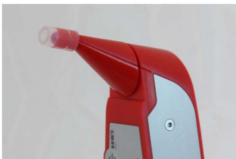
Illustrazione 8: Corretto inserimento del tubicino di silicone.
