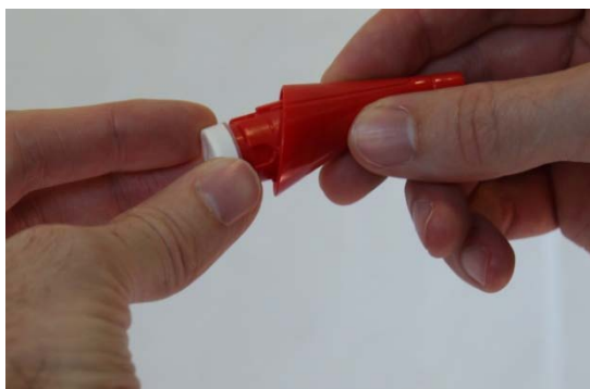
Illustrazione 12: Inserimento della membrana
