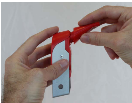
Illustrazione 10: Rimozione del boccaglio
